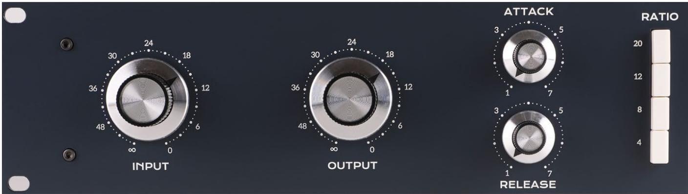
Stehen „Attack“ und „Release“ auf „1“ arbeitet der LIN76 mit extrem kurzen Regelzeiten: Für Attack sind es 20  $\mu$ S, für Release 50 mS. Das entspricht genau den 1176-Werten.
