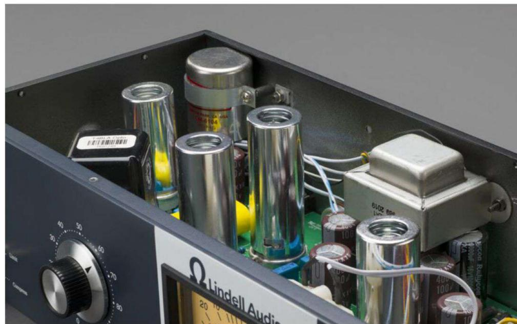
Im Innern des LIN2A sind an der Rückseite die Ein- und Ausgangsübertrager von Cinemag eingelassen. Der T4 Optokoppler von Black Lion Audio verbirgt sich in dem schwarzen rechteckigen Kunststoffblock.
