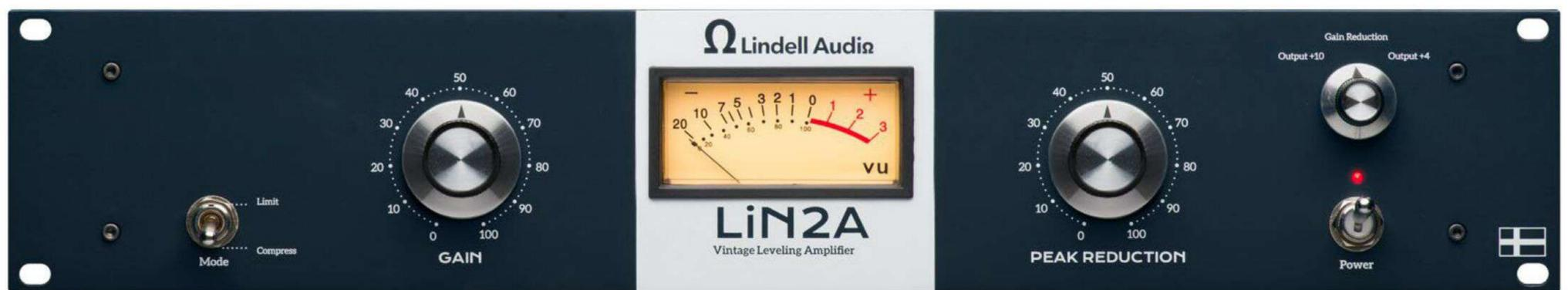
Der Lindell LIN2A ist eine Replik des legendären Teletronix LA-2A. Die Einstellung erfolgt lediglich über die Gain- und Peak-Reduction-Regler. Den Rest übernimmt der verbaute Optokoppler, der die weiteren Parameter dynamisch und in Abhängigkeit zur eingespeisten Signalstärke reguliert.
